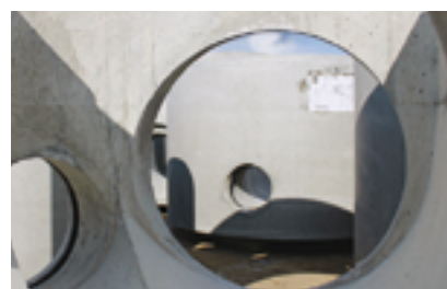
Eksempel på vådstøbt beton
