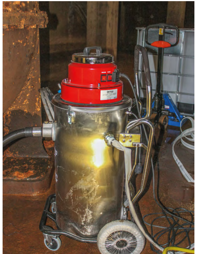
Der stilles store krav til det grej, der skal bruges i en drikkevandstank. Vandstøvsugerens er ny, alligevel er hjulene banderet. Reglerne er beskrevet i DDS (Dansk Drikkevands Sikkerhed)
