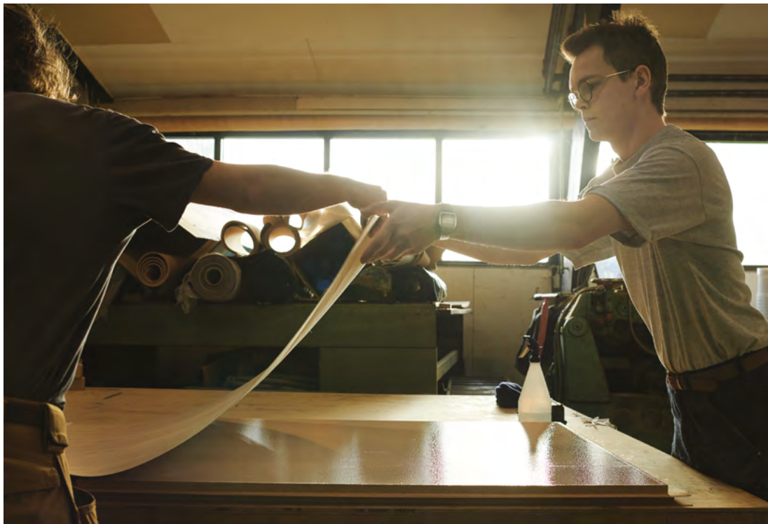
Finering er en kernekompetence som snedker. Her er to lærlinge i gang med at pålime et tyndt lag finer. Bagefter kommer planken under tryk i en speciallavet maskine
