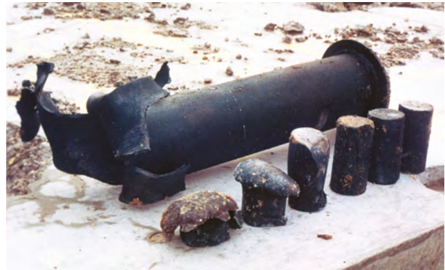
EU sprængningstest af ammoniumnitrat gødning. Billede til venstre viser opstilling før sprængning med gødning i stålrør oven på blycylindre, og billede til højre viser resultatet af testen med deformering af blycylinderene (Billederne er fra to forskellige test)
