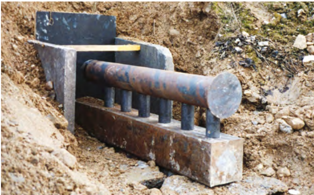
EU sprængningstest af ammoniumnitrat gødning. Billede til venstre viser opstilling før sprængning med gødning i stålrør oven på blycylindre, og billede til højre viser resultatet af testen med deformering af blycylinderene (Billederne er fra to forskellige test)
