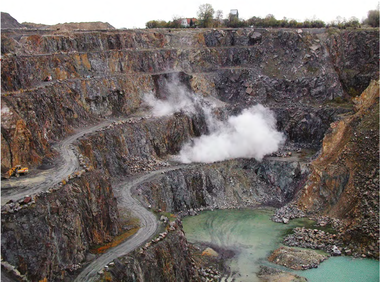
Sprængning i Rønne Granitbrud, NCC Roads. Nederst ses bænke, der er klargjort til sprængning. Billede nederst til højre viser udsprængning af bloksten, Surface.
