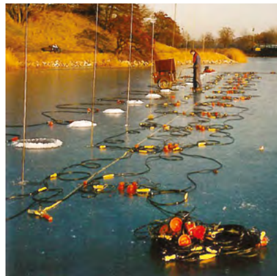
Refraktionsseismiske undersøgelser på Stadsgraven i forbindelse med den første metro i København, isvinteren 1996-97. Til venstre bores et hul i isen hvor i ladningen på 100 g efterfølges sænkes ned i. Foto: Uffe Nielsen, Rambøll
