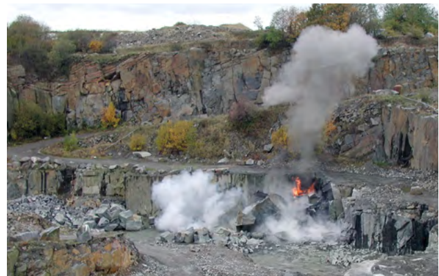
Sprængning i Rønne Granitbrud, NCC Roads. Nederst ses bænke, der er klargjort til sprængning. Billede nederst til højre viser udsprængning af bloksten, Surface.
