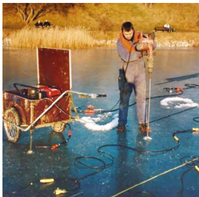
Refraktionsseismiske undersøgelser på Stadsgraven i forbindelse med den første metro i København, isvinteren 1996-97. Til venstre bores et hul i isen hvor i ladningen på 100 g efterfølges sænkes ned i. Foto: Uffe Nielsen, Rambøll
